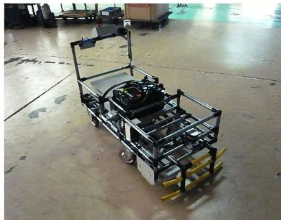
インテリジェントAGV制御システム
